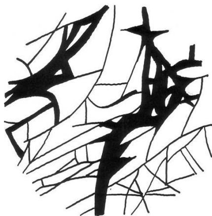
Рис. 3. Сетчатая текстура замещения пирита (белое) лимонитом (черное). Увеличение 100 × (Пьязбашинское месторождение).
